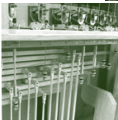
Tonmechanik an der Windlade
